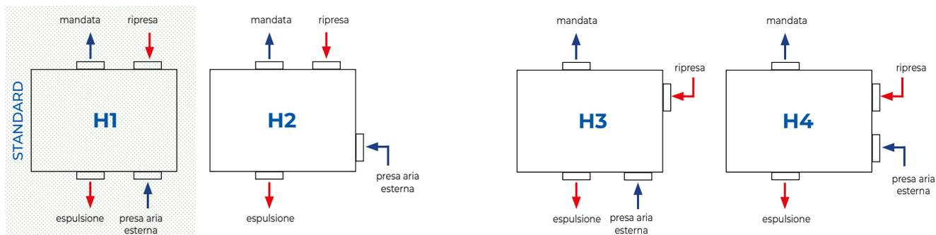
N.B.: Gli attacchi dell'aria sono configurabili in fase di installazione attraverso i pannelli removibili, operazione facilmente eseguibile in loco.
