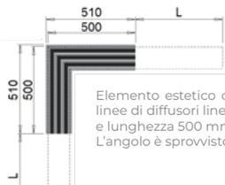
Elemento estetico di raccordo tra i due linee di diffusori lineari con angolo di 90° e lunghezza 500 mm per lato. L'angolo è sprovvisto di deflettori.
