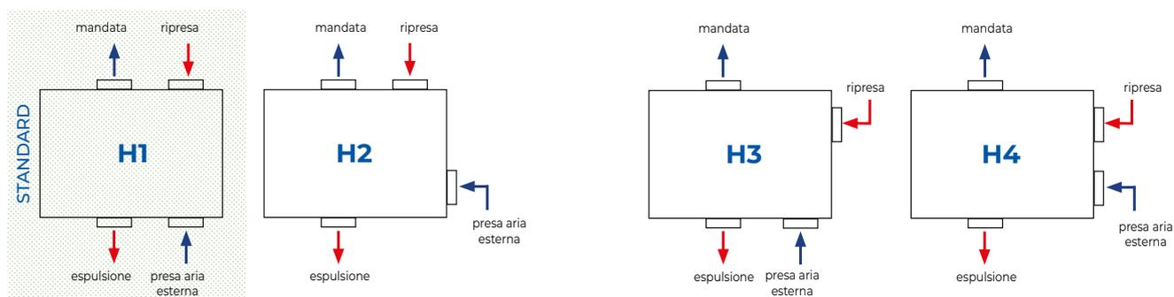
N.B.: Gli attacchi dell'aria sono configurabili in fase di installazione attraverso i pannelli removibili, operazione facilmente eseguibile in loco.
