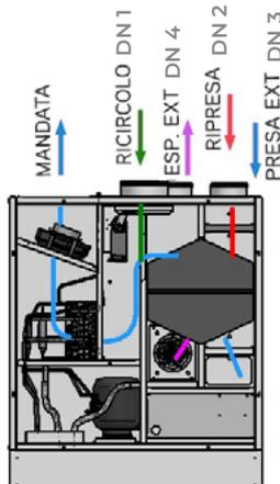
La ventilazione meccanica con recupero di calore ad alta efficienza continua a essere soddisfatta dall'unità, tuttavia, si incrementa la portata d'aria reintroducendo aria nell'ambiente tramite un condotto dedicato, al fine di aumentare il volume d'aria nella zona di integrazione.
