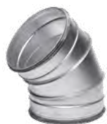
CURVA 45° A SETTORI Curva 45° stampata a settori con guarnizione in gomma EPDM, per canali circolari.
